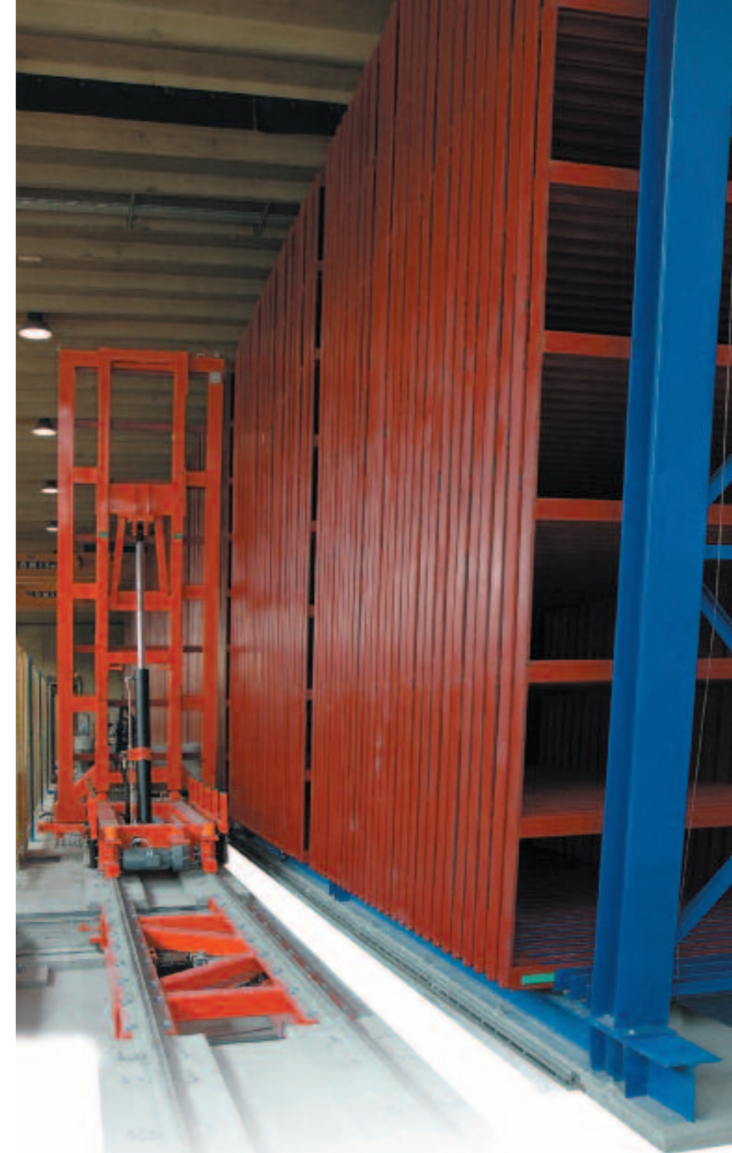
Pohled na sklad s pohyblivým rámem zabudovaným do nosné struktury pevného podstavce
