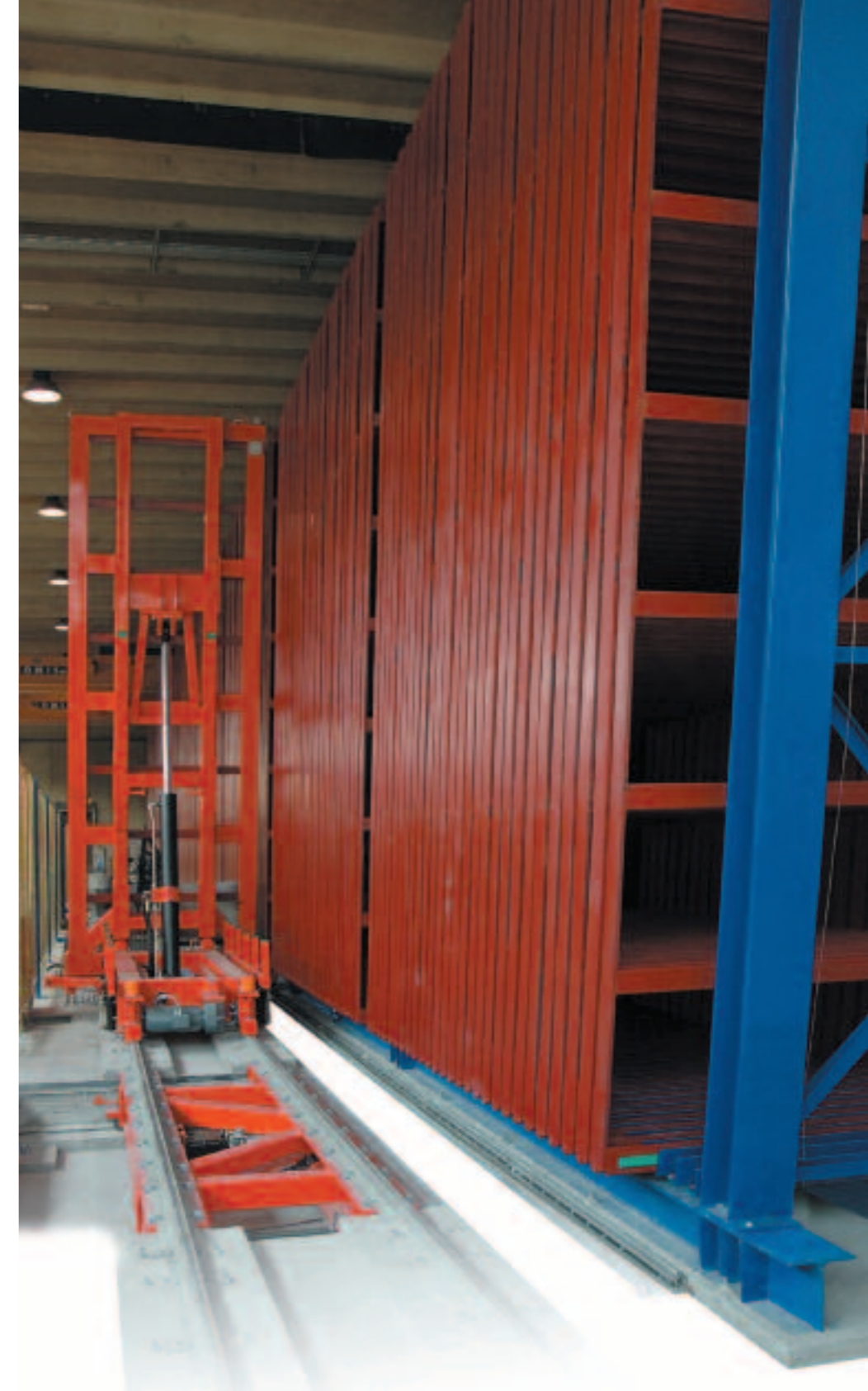
Vista del magazzino con il telaio mobile installato sulla struttura portante del telaio fisso
