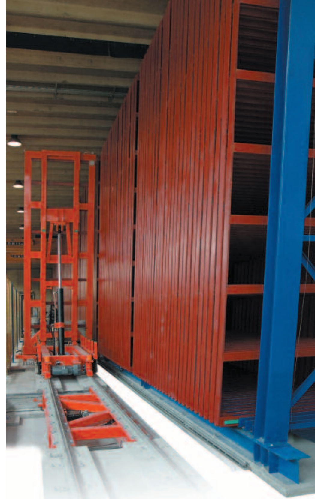
Ansicht des Lagers mit den in die tragende Struktur des festen Gestells eingebauten beweglichen Rahmen
