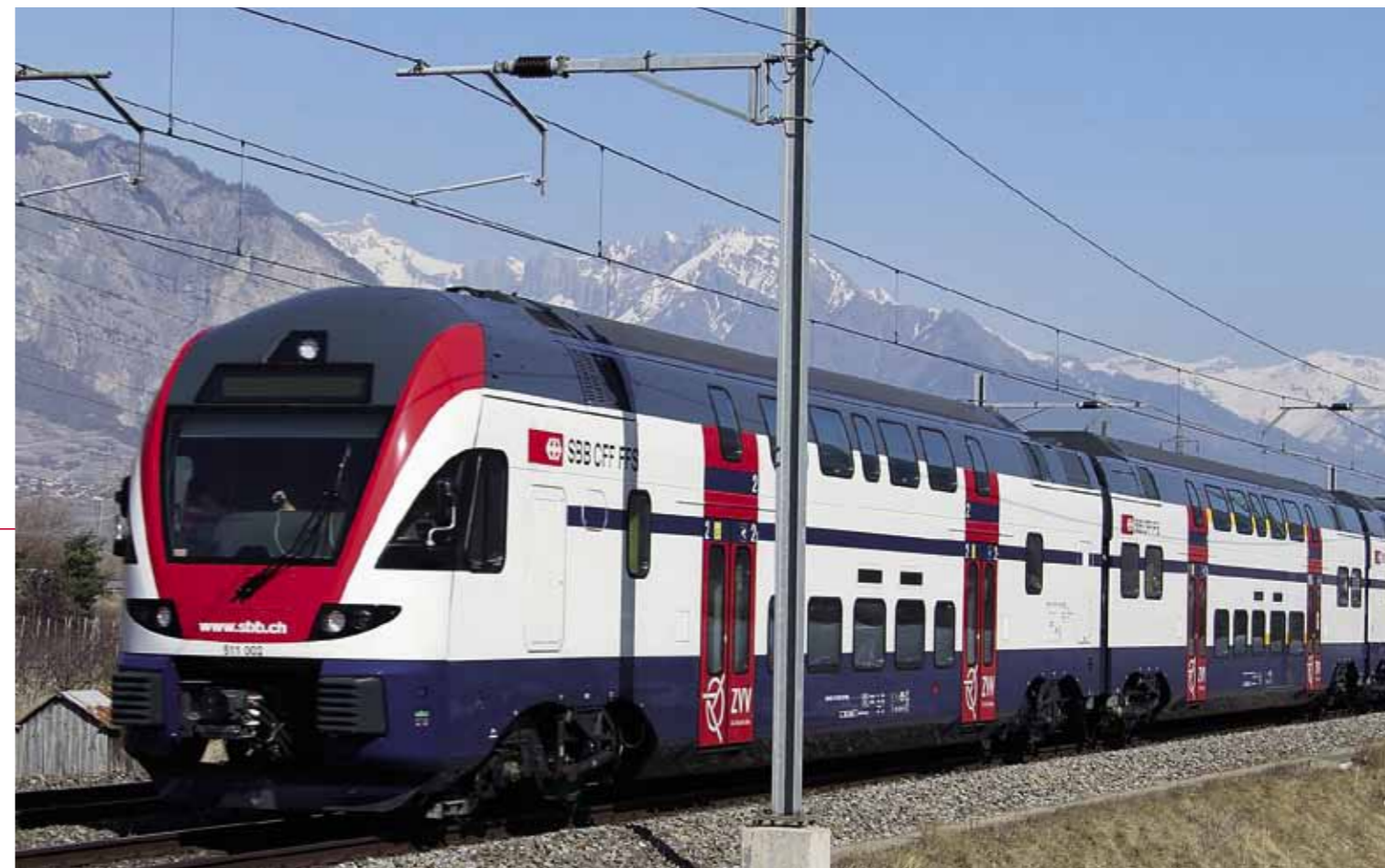
Avec leurs fenêtres bombées, les étages supérieurs des trains imposent des exigences de construction particulières de par leurs paramètres géométriques
