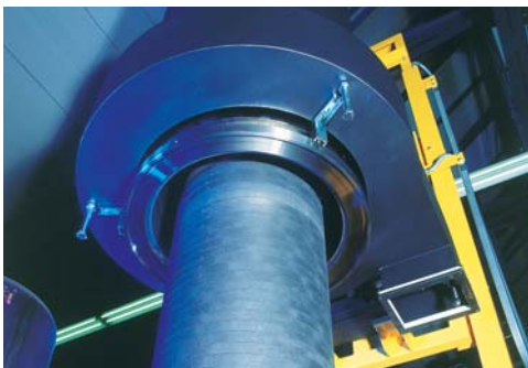
Grafitová těsnění pro vysokoteplotní reaktory
