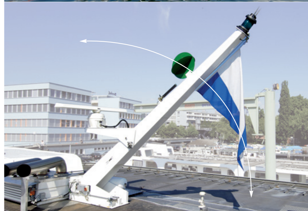
Hoofdmast wordt neergelaten
