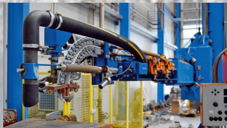
Saldatura ad arco sommerso in tandem – testina di saldatura interna
