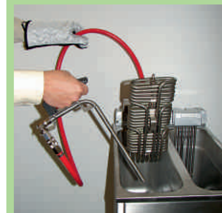
Das Frittierbecken wird gespült und gefüllt.
