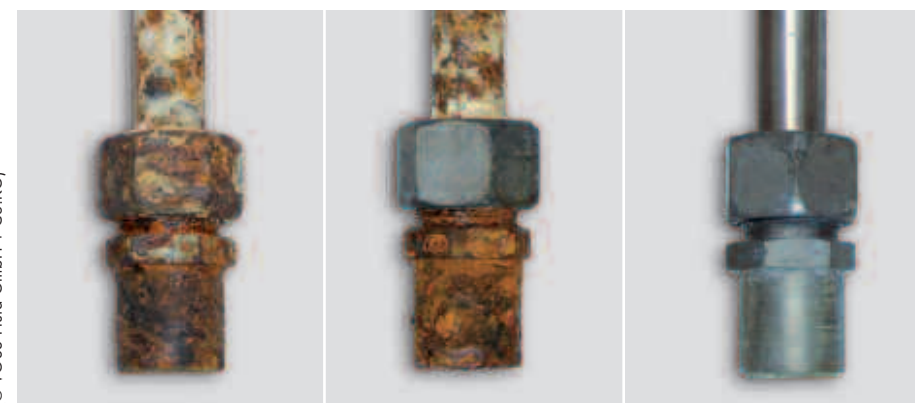
zingué, chromaté jaune zingué, passivé, scellé, sans Cr(VI) zingué nickelé, passivé, scellé, sans Cr(VI)
