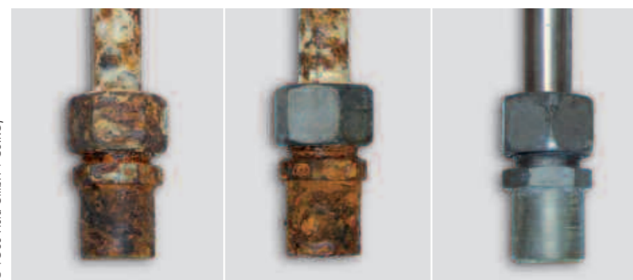
Verzinkt geelchromateerd Gegalvaniseerd gepassiveerd verzegeld Cr(VI)-vrij Zink-nikkel gepassiveerd verzegeld Cr(VI)-vrij
