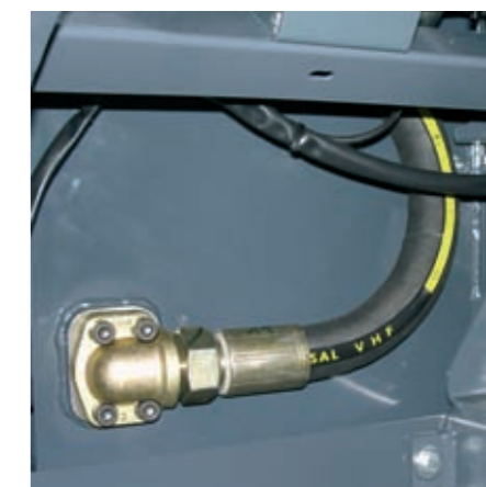
Der Saug- und Druckschlauch UNIVERSAL VHF passt auch bei engen Platzverhältnissen.
