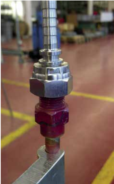
Die Dichtigkeit der Anschlussstücke für die Kühlleitungen ist garantiert, das ergeben erste Tests.
