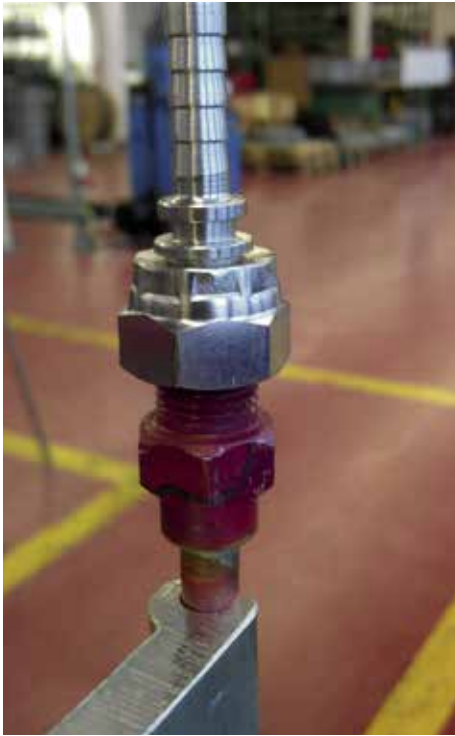
L'étanchéité des raccords à sertir des conduites de refroidissement est garantie, comme l'ont montré les premiers tests.
