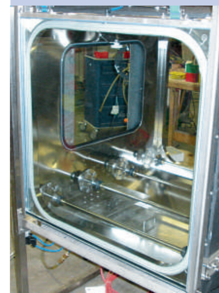
Frontansicht der Beschickungsöffnung mit umlaufendem AIRMATIC® Dichtsystem
