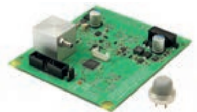
Figura 2. Modulo di rilevazione dell'ossigeno FCX-MC25-FLOW-A-CH OEM sviluppato per applicazioni in atmosfera controllata.
