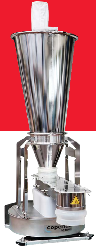
Le bouchon en silicone blanc de la balance doseuse protège l'électronique, sans perturber les vibrations dues au transport des marchandises en vrac.
