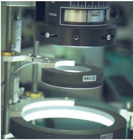
L'inspection visuelle d'un joint torique au microscope chez MCM en Italie.
