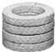
Hochverschleissfeste DIAPLEX® geflochtene Packung aus gesponnenem Aramidgarn, mit PTFE kriechdicht gefüllt, mit Einlaufgleitmittel versehen.
