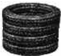
DIAPLEX® geflochtene Packung aus Graphitgarn mit PTFE-Imprägnierung und Gleitmittelzusatz.
