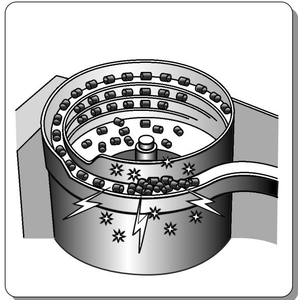
fehlerhafte Werkstückausgabe an Entladevorrichtungen
