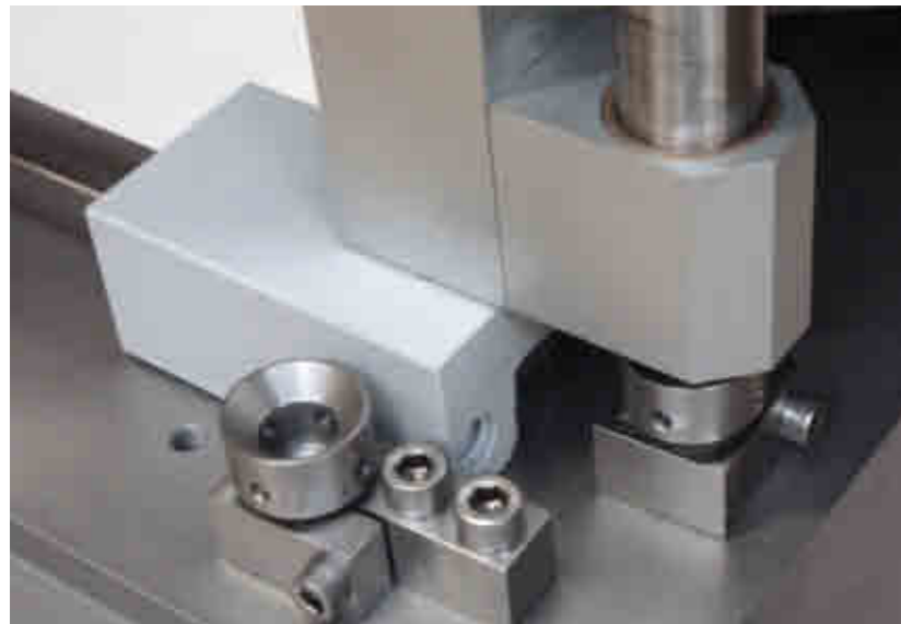
Führungsblock aus APSOplast® PET-C SL.
