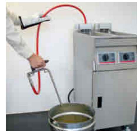
Das heisse Öl wird abgepumpt.
