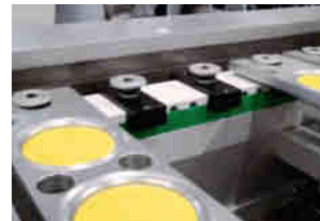
Befestigung der Kapselträger am Zahnriemen.
