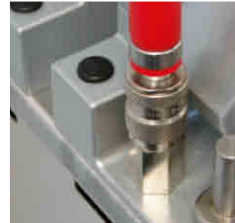
Vorangepasste Edelstahlringe statt Schlauchklemmen.
